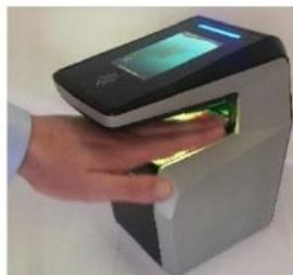
カバーと光学センサーの間に手を挿入します
